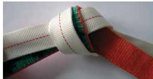
Nœud de sangle : facile à retenir, faire un nœud simple, puis faire le chemin inverse avec l'autre sangle. La résistance tombe à 44 % de la résistance initiale.
