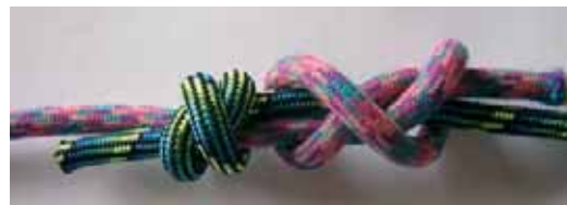
Nœud de pêcheur double : la résistance de la corde est affaiblie jusqu'à 56 % de sa valeur initiale. C'est l'un des meilleurs, mais il est difficile à retenir !
