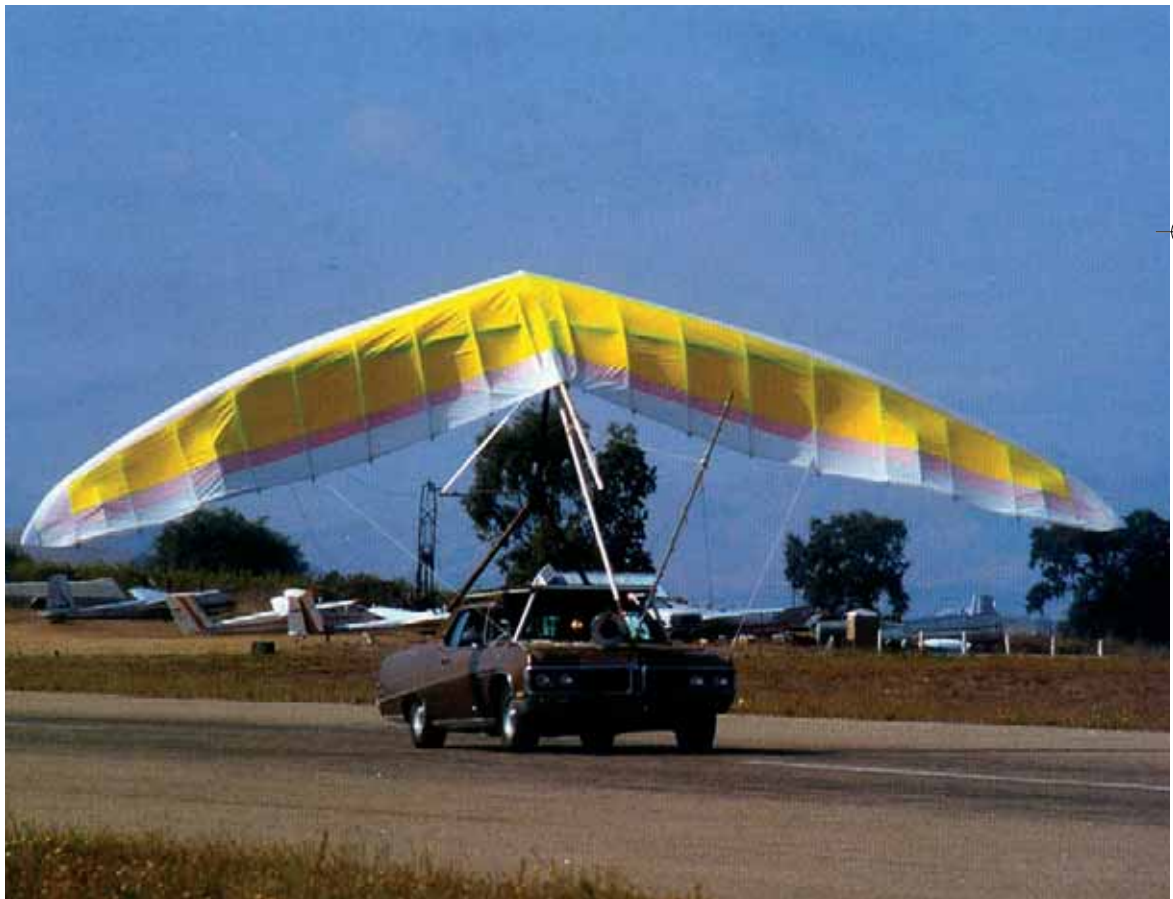
Le delta est ici testé « en négatif » sur le véhicule test, il doit tenir minimum 3 g en négatif.
