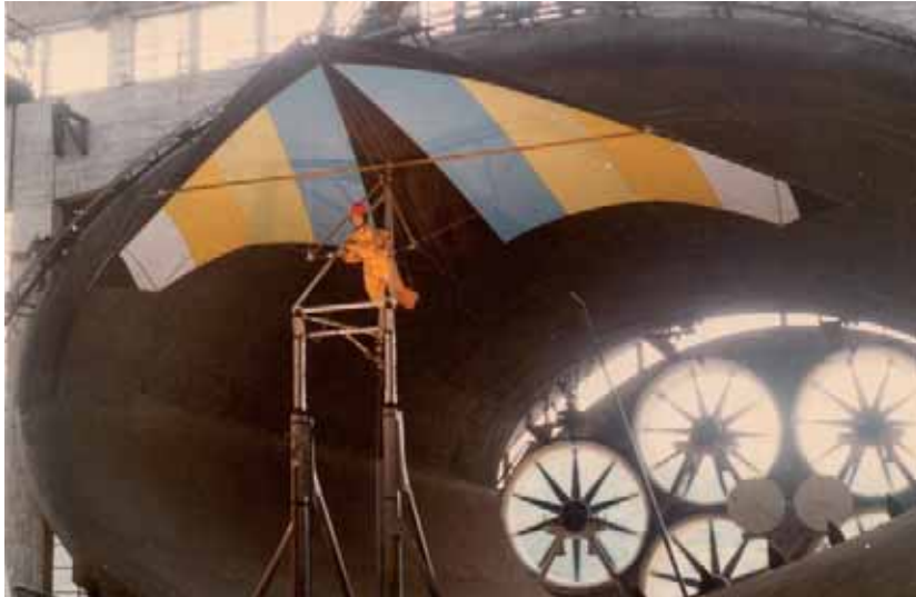
Essais en veine avec mannequin dans la soufflerie S1 de l'ONERA en 1976. L'aile est une Mouette C, d'abord considérée comme aile performante, elle a ensuite beaucoup servi en école.
