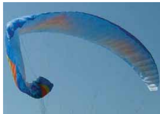
La cravate : dans quelques cas rares de fermeture, la détente d'une partie du suspentage permet qu'une partie de la voile s'y verrouille.
