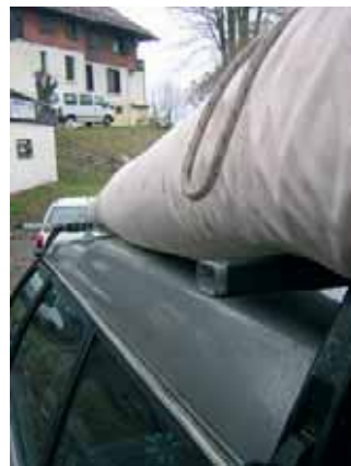
La corde échappe de la barre de toit, l'arrière n'est plus attaché !
