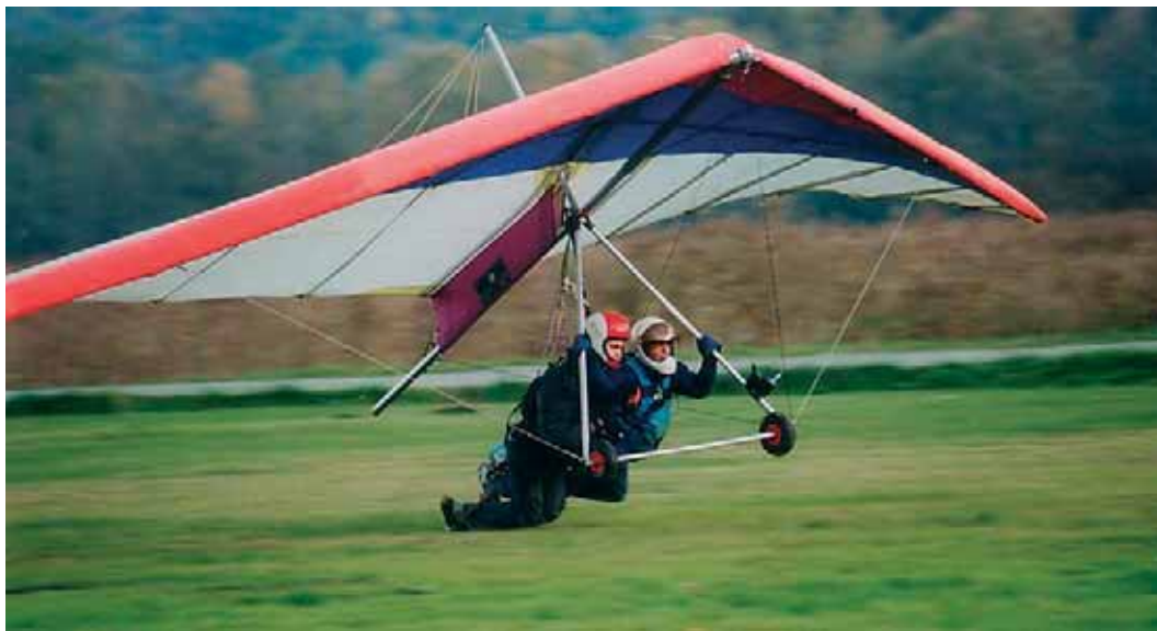
Le posé « roulettes » est une solution très confortable en biplace, spécialement avec un vent capricieux.
