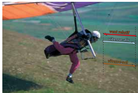
Vent nul, faible pente, le pilote à la fin de son envol fait de larges foulées « aériennes » pour courir vite sans effort.
